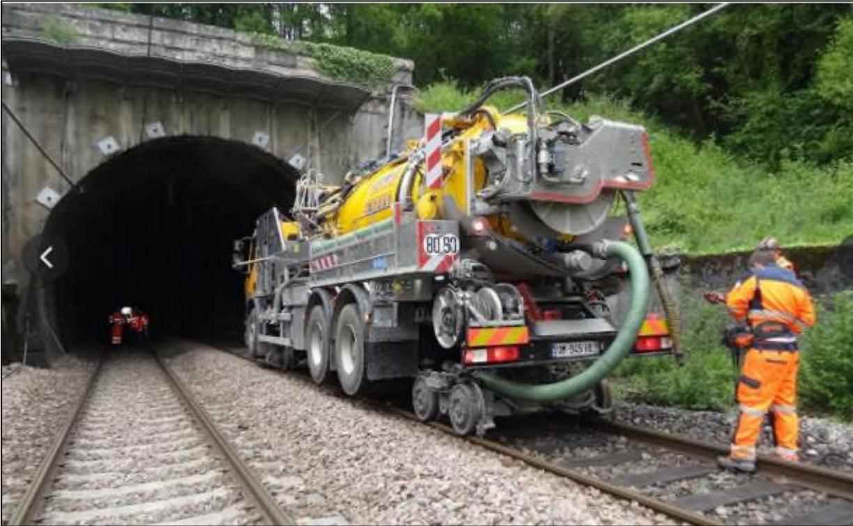
Figure 8 | Photographie d'un camion Rail Route Hydrocurage. Source : SNCF Réseau
