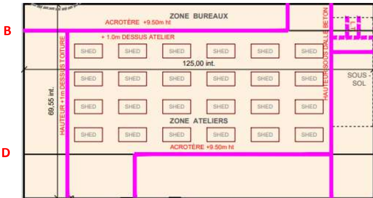
FIGURE 21 : IMPLANTATION DES PAROIS REI120 (EN ROSE)
