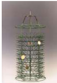
FIGURE 13 : PHOTO D'UN BOUCLARD UTILISE EN GALVANOPLASTIE
