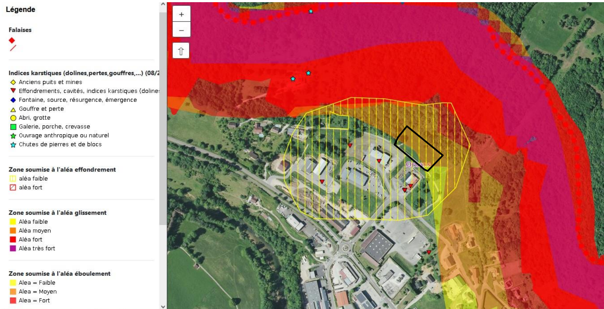
Figure 6 : Source : atlas des secteurs à risques de mouvement de terrain du Doubs © IGN-BRGM-GIPEK-CDS du Doubs-DDT25-DREAL FC
