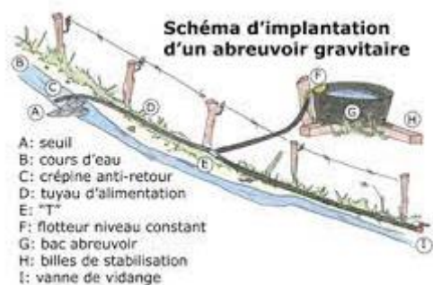
Figure 14 : Schéma de principe de l'installation des abreuvoirs gravitaires (Contrat de rivière Lesse).
