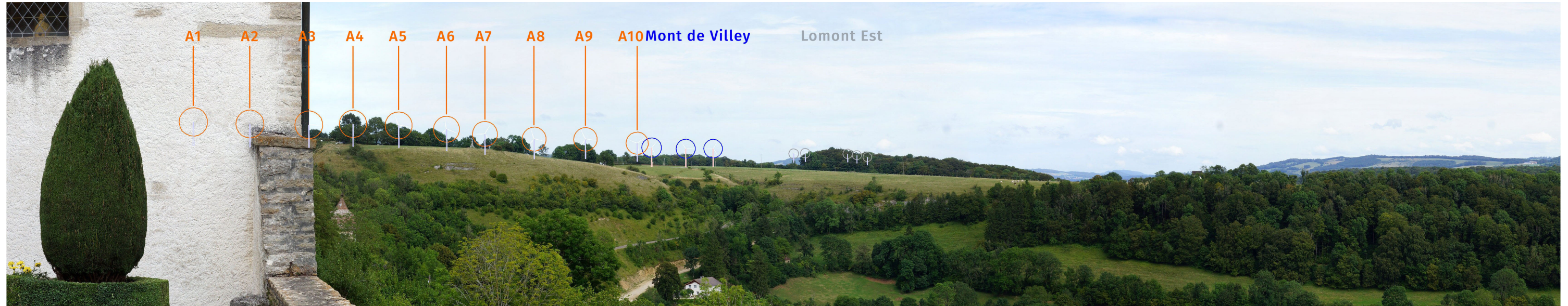
Variante A : 10 éoliennes d'une hauteur totale de 180 m, implantées aux mêmes emplacements que le parc existant (panorama dans un angle de 84°)
