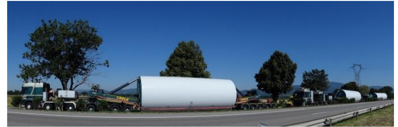
Illustration 16 : Transport d'éléments de mât (Opale)
