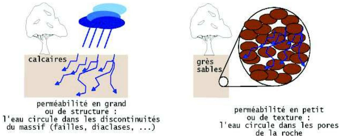
*Illustration 19: perméabilité de structure et perméabilité de texture*
