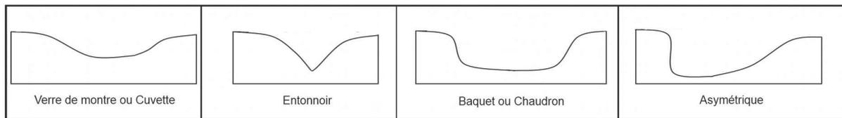
Illustration 15: Schéma des différentes morphologie de dolines
