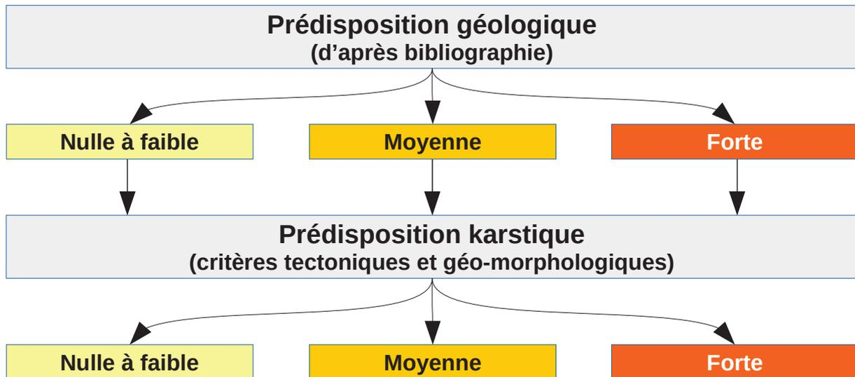
Illustration 23: principe de détermination du niveau d'aléa karstique.
