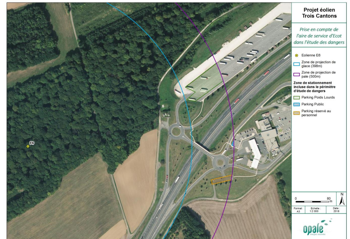
Carte 6 : Prise en compte de l'aire de service d'Ecot dans l'étude des dangers
