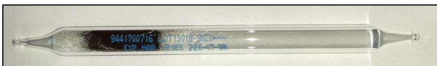
Figure 17 : Support de prélèvement Hopcalite, mesure du mercure
