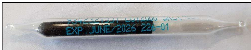
Figure 15 : Support de prélèvement "Petit Tube CA", mesure d'Hydrocarbure, de COHV et des BTEX
