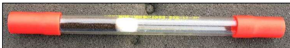
Figure 18 : Photographie du support de prélèvement après utilisation
