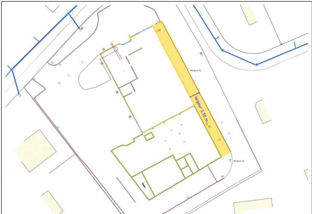
Figure 5 : Zone concernée par les travaux pour mise en place de la voie d'accès au dévidoir
