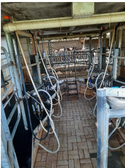
Figure 3 Salle de traite Epi 2*3
