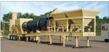
$\label{eq:Figure 2} \textit{Figure 2}: \textit{Exemple de centrales mobiles d'enrobage a chaud}.$
