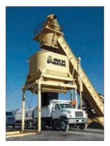
FIGURE 8 : EXEMPLE DE TREMIE ET SILO DE STOCKAGE D'ENROBE.
