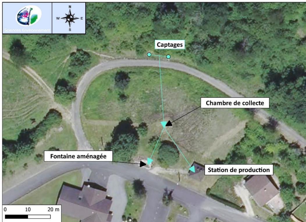
Figure 4 : Schéma de fonctionnement des captages
