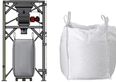
Figure 37 : Visuel des Big-bags + coupe trémie de déversement en sortie de phase de tri
