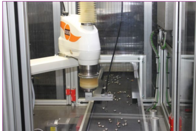
Figure 12 : Convoyeur avec robot + son dispositif d'aspiration des piles (cadence 2.1 s par pile)
