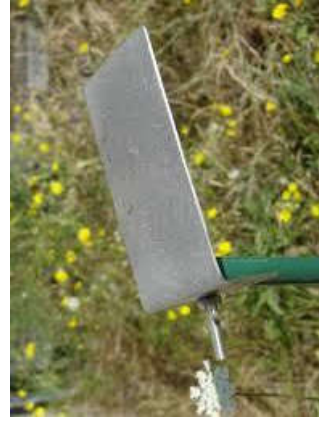
Figure 15 : Photographie du système de mesure d'empoussièrément par plaquette.
