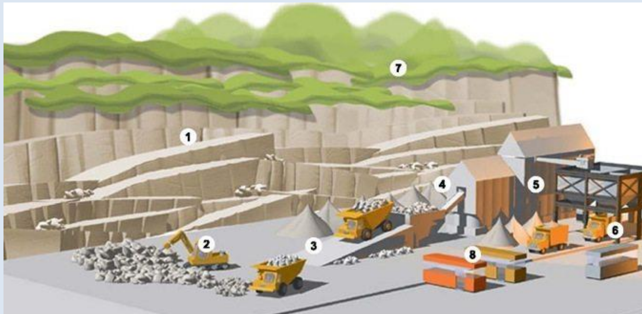
Figure 3 : Schéma conceptuel du fonctionnement d'une carrière de roche massive Source : www.foraloc.fr (8 : « pilotage des installations, bureau et laboratoire d'analyses »)
