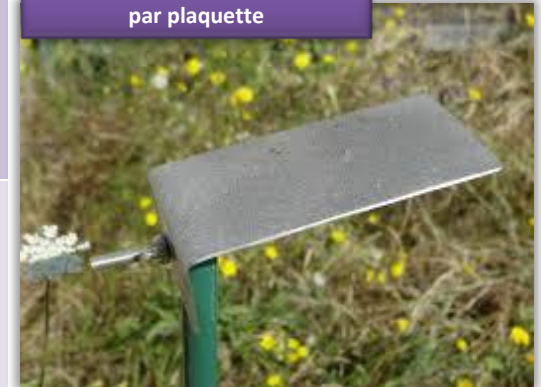
Mesure d'empoussièrement par plaquette
